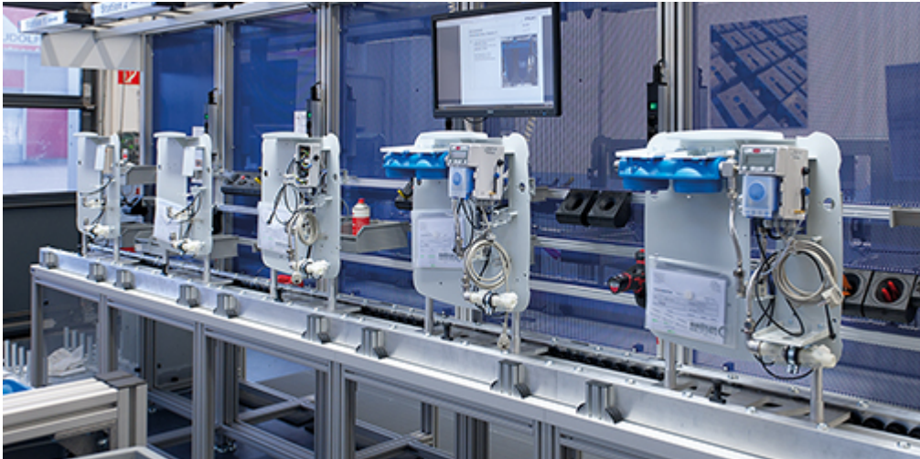
Fertigung der innovativen Heizungswassermodule in der Produktionsstätte Seevetal.
